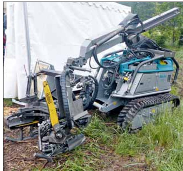
Auf der „KWF-Tagung“ in Schwarzenborn im vergangenen Jahr stellte Prof. Erler mehrere Prototypen vor, die an seinem Lehrstuhl entwickelt und konstruiert wurden. Darunter war ein speziell für die Laubholzernte entwickelter Harvesterkopf (links) und eine mit Pflanzelt gemeinsam entwickelte funkkferngesteuerte Raupe zum gefahrlosen Fällen. Fotos: Ißleib (3)
