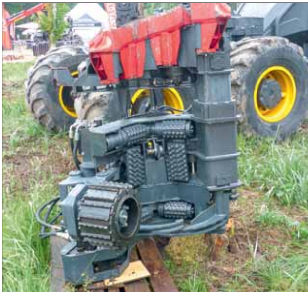
Auf der „KWF-Tagung“ in Schwarzenborn im vergangenen Jahr stellte Prof. Erler mehrere Prototypen vor, die an seinem Lehrstuhl entwickelt und konstruiert wurden. Darunter war ein speziell für die Laubholzernte entwickelter Harvesterkopf (links) und eine mit Pflanzelt gemeinsam entwickelte funkkferngesteuerte Raupe zum gefahrlosen Fällen. Fotos: Ißleib (3)
