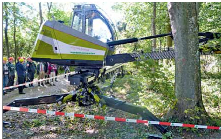
2013 wurde auf den „KWF-Thementagen“ in Schuenhagen (Mecklenburg-Vorpommern) neben einem speziell für den Einsatz im Flachland konzipierten Seilkran auch ein 1:1-Funktionsmodell eines Portalschreitwerks gezeigt (vgl. HZ Nr. 35 vom 30. August 2013).
